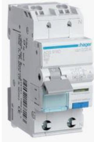
Am FI/LS Schalter befindet sich eine Prüftaste (T), mit der die Funktion des Gerätes geprüft werden kann. Von einem Außenleiter führt ein Strompfad außerhalb am Summenstromwandler vorbei zum Neutralleiter. In diesem Strompfad befindet sich die Prüftaste und ein Widerstand, der die Höhe des Differenzstromes bestimmt. Bei Betätigung der Prüftaste wird ein Fehlerstrom simuliert, der den Ansprechwert des Fehlerstrom-Schutzschalters übersteigt und zur Auslösung bringt.
